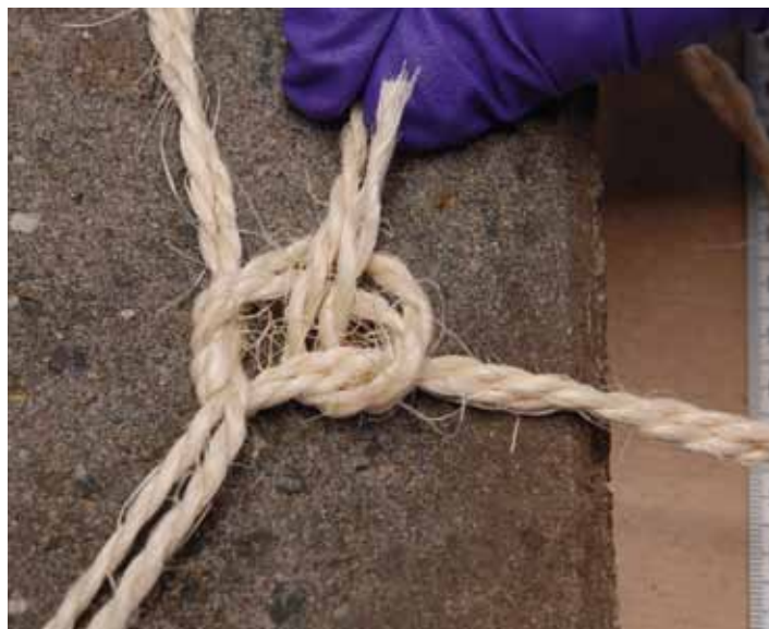
Samengestelde knoop van een enkele overhandse knoop met hierover een halve steek.
