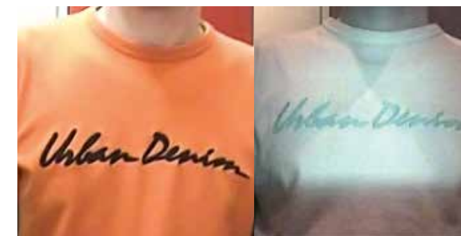
Figuur 5 Hetzelfde shirt, links gezien met een normale camera, rechts gezien met een camera met een beperkt NIR-filter.
