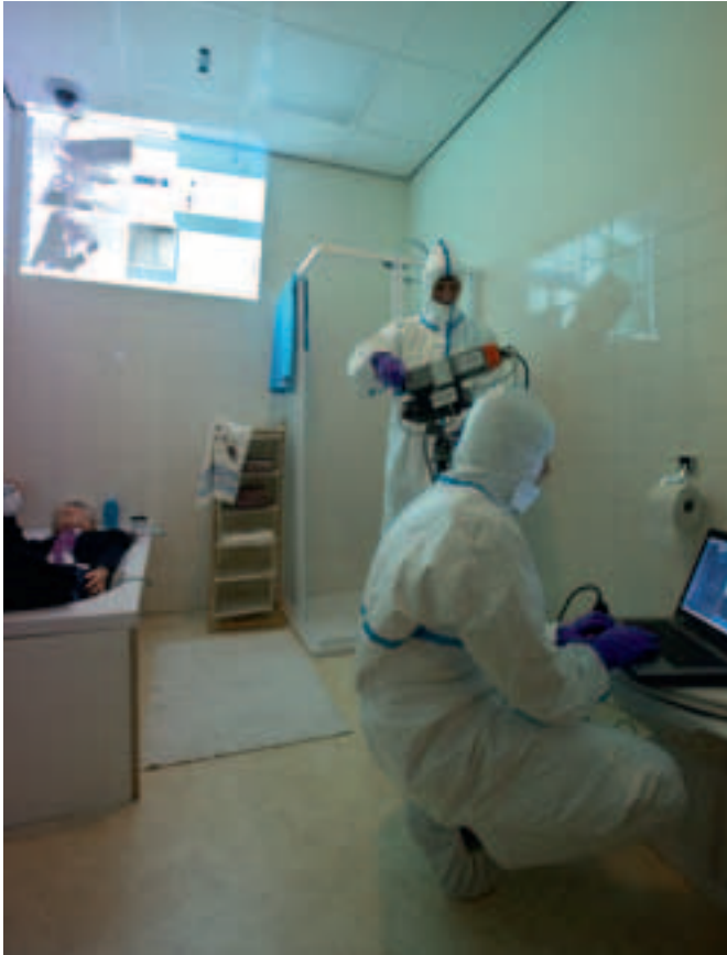
Onderzoekers van het AMC demonstreren de spectrale camera, die bloedvlekken zichtbaar maakt.
