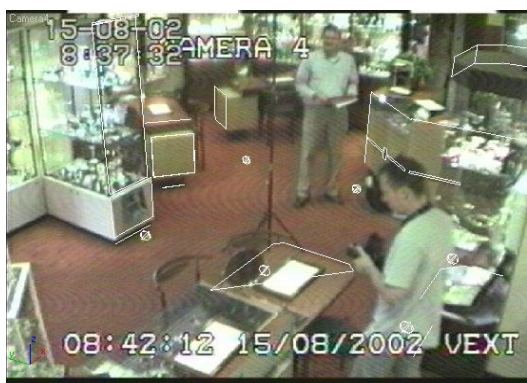
Figuur 3. Eenvoudig driedimensionaal computermodel geprojecteerd op het camerabeeld.
