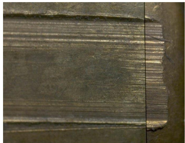
Foto 1. Foto gemaakt met een vergelijkingsmicroscop. Links en rechts van de deellijn: kraslijnen in de groeven in twee kogels.
