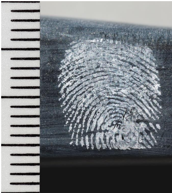
Figuur 9. Een met TiO 2 zichtbaar gemaakt dactyloscopisch spoor op een zwart kunststof heft van een mes.
