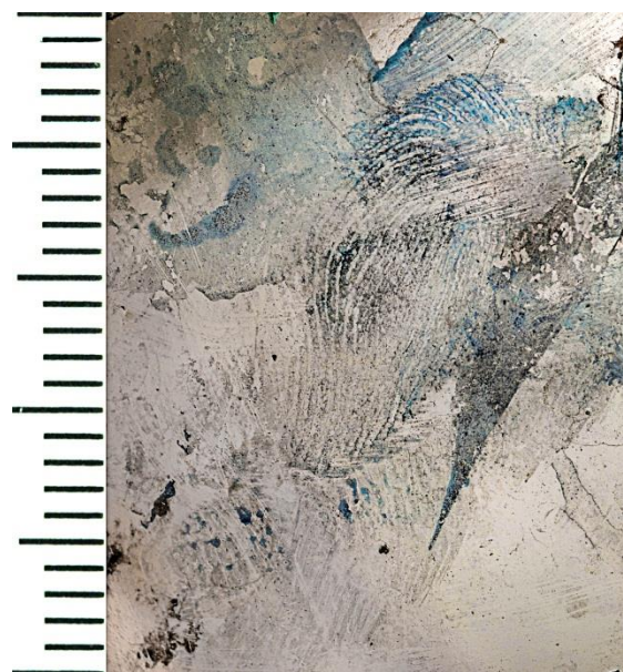
Figuur 8. Een met amido black zichtbaar gemaakt dactyloscopisch spoor op een plastic zak.
