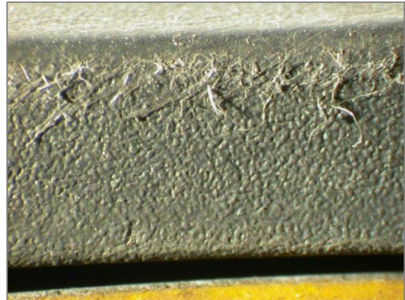
Figuur 3. Versmolten vezels in de bumper van een auto.
