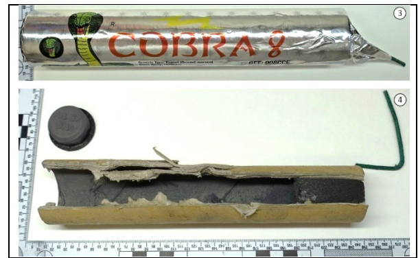
Foto 3. Voorbeeld van een intacte Cobra 8 met voorlading.
