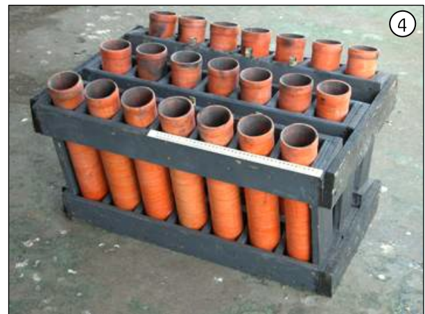
Foto 4. Voorbeeld van rek met 21 mortieren.
