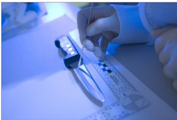
Afbeelding 4: een mes wordt met een bevochtigde wattenstaaf bemonsterd.
