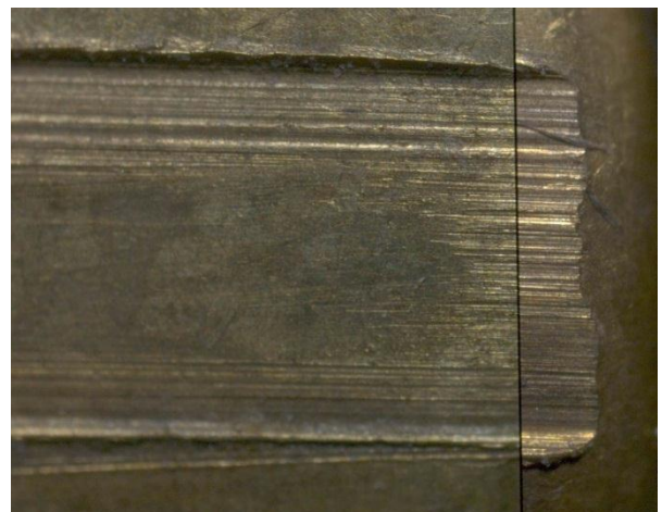
Foto 1. Foto gemaakt met een vergelijkmicroscop. Links en rechts van de deellijn: kraslijnen in de groeven in twee kogels.
