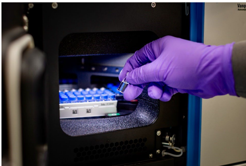
Figuur 8 Autosampler met glazen monsterflesjes voor analyse met vloeistofchromatografie (LC).
