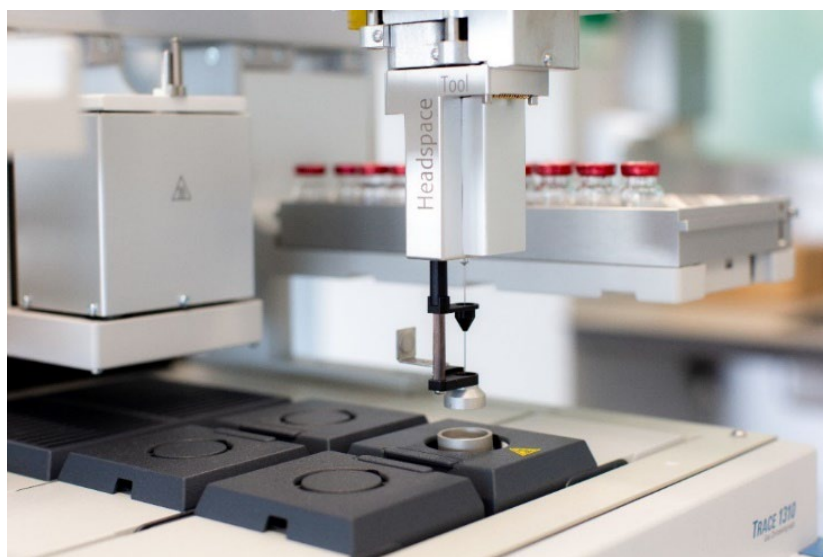
Figuur 6 Een monster genomen uit een van de monsterflesjes wordt geïnjecteerd in de GC-MS.
